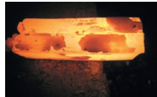
In dit smeedstuk zijn de verschillende laagjes ijzer te zien.
