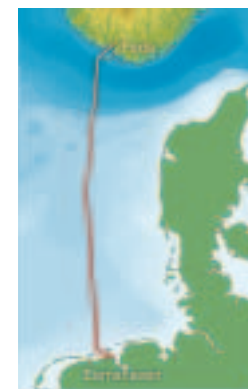
Het 580 km lange traject van de kabel tussen Noorwegen en Nederland. Het diepste punt ligt bij Noorwegen op zo'n 460 m.
