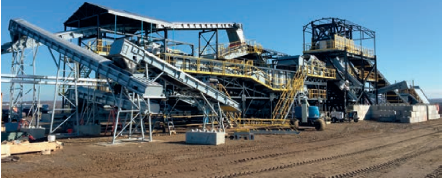
De puinbreker van Putman in Westervoort haalt met behulp van de Advanced Dry Recovery-techniek kleine verontreinigingen als koper uit het puin.
