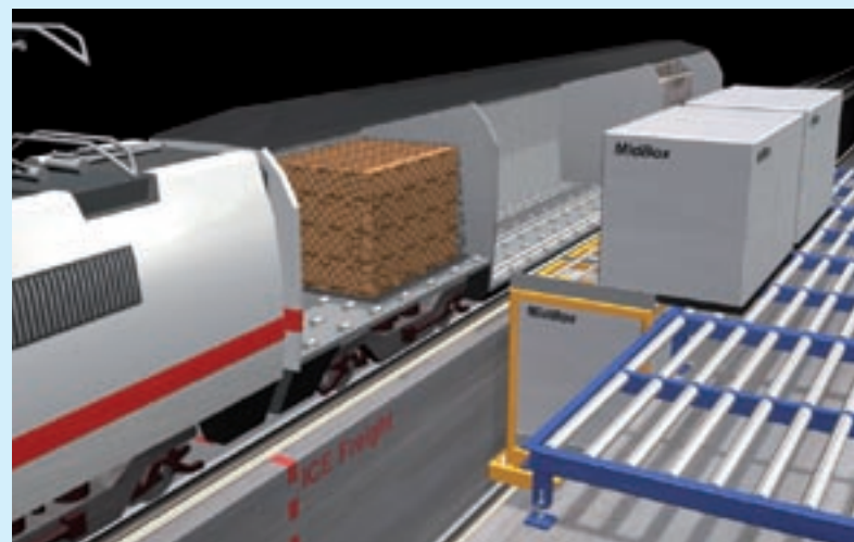
Een ingenieus liftsysteem zorgt ervoor dat de goederen treinen binnen drie minuten worden gelost en geladen.
