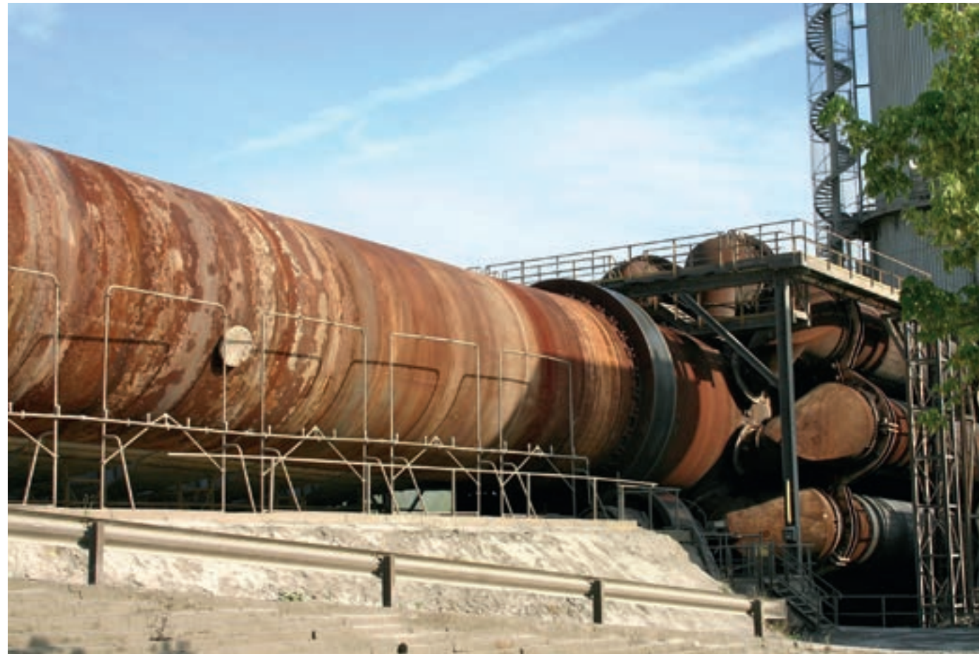
In een cementoven wordt kalksteen gebrand tot klinker.
