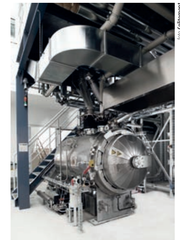
De autoclaaf bij het KIT, die op beperkte schaal celiet-cement maakt.
